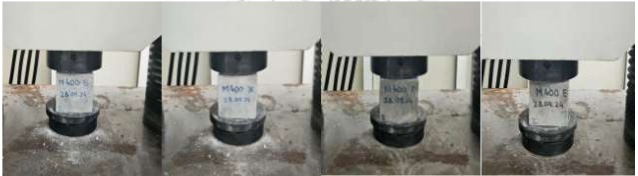
4-rasm. B30 (M400) sinfli betonning gidravlik pressda siqilishga bo'lgan mustahkamligini sinash
