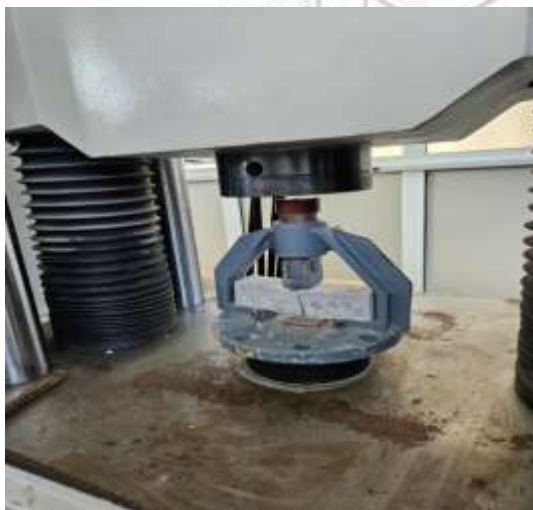
2-rasm. Portlandsementning MIG-1000 rusumli gidravlik pressda mustahkamligini sinash jarayonlari.
