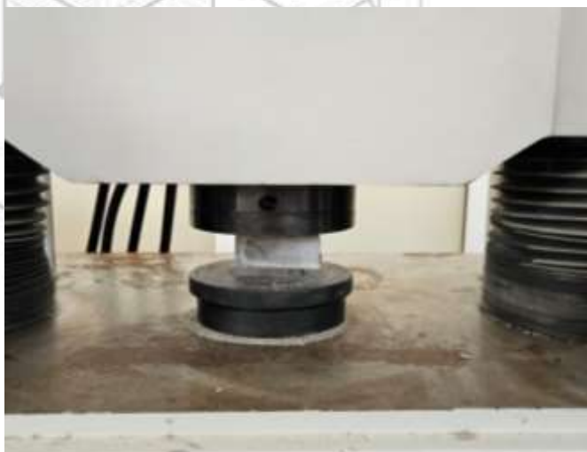
2-rasm. Portlandsementning MIG-1000 rusumli gidravlik pressda mustahkamligini sinash jarayonlari.
