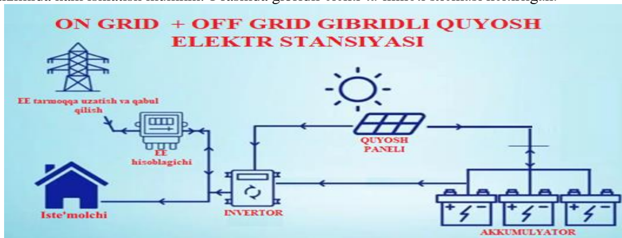
1-rasm. ON GRID + OFF GRID gibridli quyosh elektr stansiyasining elektr ta'minot sxemasi
