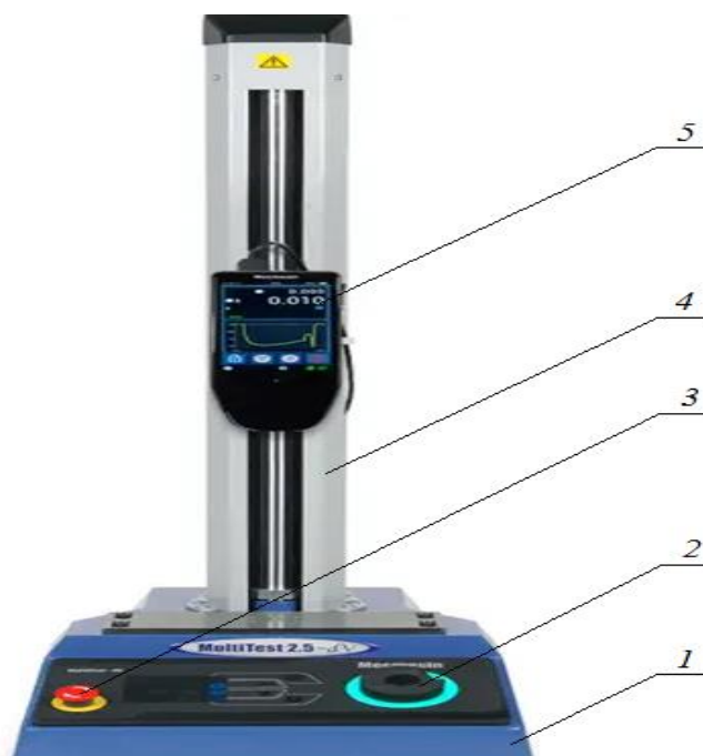
Рис 1. Общий вид вертикальной электромеханической машины MultiTest-dV
