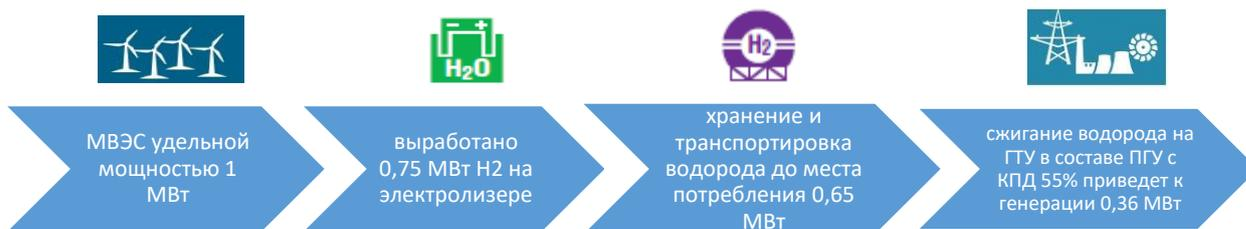
Рис. 2 Коэффициент преобразования электроэнергии
