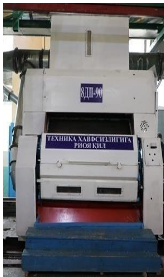
1-расм. Такмиллаштирилган қозикли барабанга эга бўлган 90 аррали жиннинг ишлаб чиқаришдаги кўриниши
