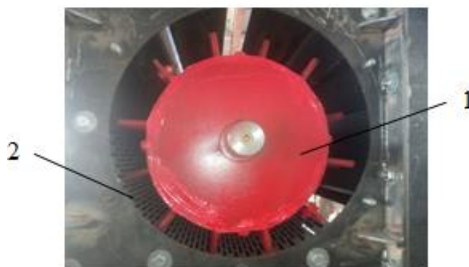
1-расм. Жин таъминлагичига ўрнатилган такомиллаштирилган қозикли барабани саноат-тажриба нусхасини кўриниши 1-қозикли барабан, 2- тўрли юза
