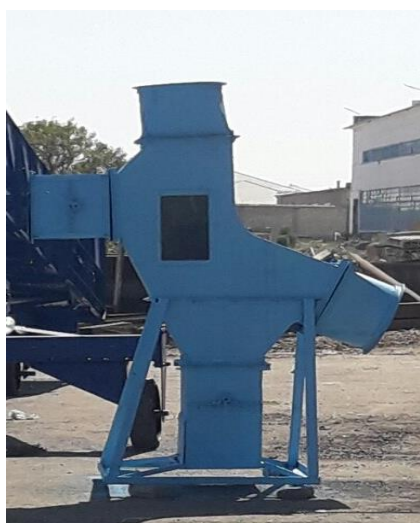
4-расм. Такмиллашган янги конструкциядаги тоштутгич қурилмаси
