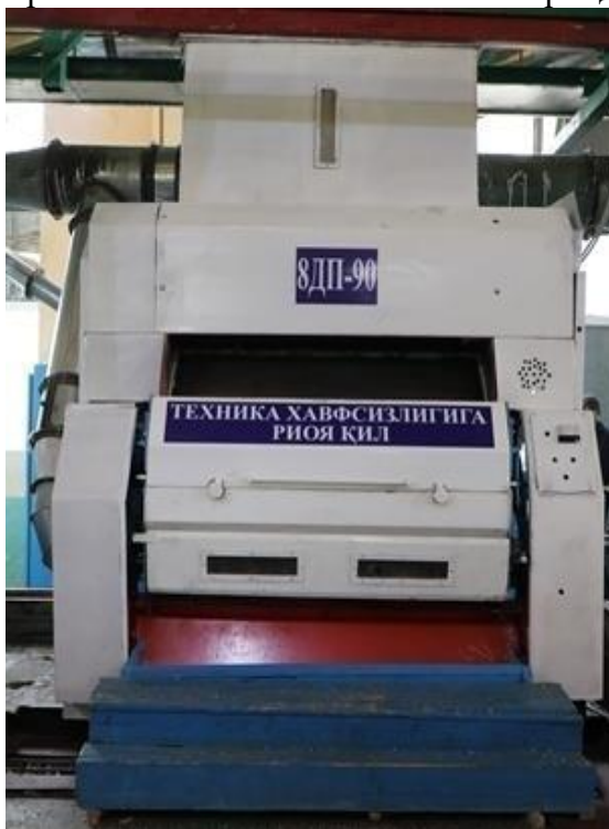
3-расм. Такомиллаштирилган қозикли барабанга эга бўлган 90 аррали жиннинг ишлаб чиқаришдаги кўриниши
