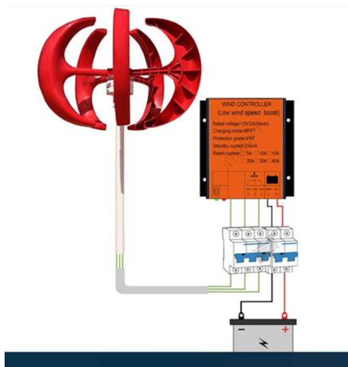
Рис 2. Ветрогенератор с контроллером МРРТ
