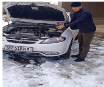
1-rasm. 4-avlod GBU bilan jihozlangan GBA dvigateliga o'rnatilgan gaz elektron boshqaruv blokini diagnostika kabeli orqali noutbuk bilan ulash jarayoni
