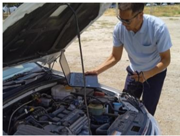
1-rasm. 4-avlod GBU bilan jihozlangan GBA dvigateliga o'rnatilgan gaz elektron boshqaruv blokini diagnostika kabeli orqali noutbuk bilan ulash jarayoni
