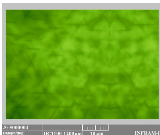
Рис. 4. Микрофотография образца кремния полученного трехстадийной диффузией гадолия при относительно высоких конечных температурах и длительных временах выдержки
