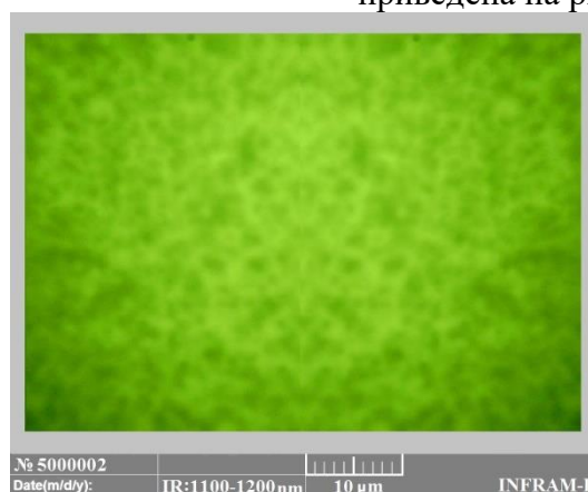
Рис. 2. Микрофотография образца кремния легированного гадолинием поэтапной низкотемпературной диффузией
