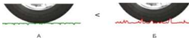
Рис. 2. Сравнение шума при движении по покрытию с различными параметрами макропрофиля
