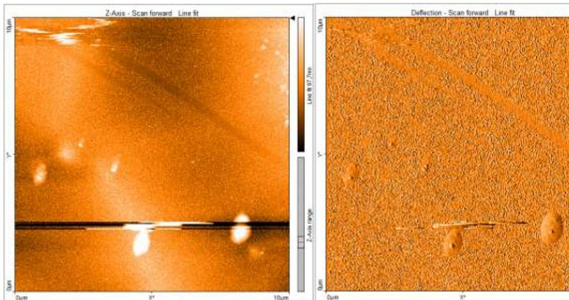
2-rasm. Ni/SiO<sub>2</sub>/p-Si gibridd nanostrukturasining AKM statik kuch maromida olingan 2D tasviri.
