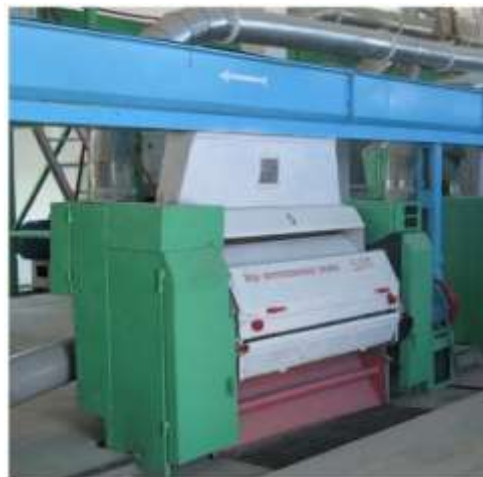
4- расм. Аррали цилиндри қувурли вал билан такомиллаштирилган 5ЛП линтернинг ишлаб чиқаришдаги кўриниши
